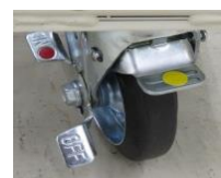
旋回固定切替機構 キャスター
